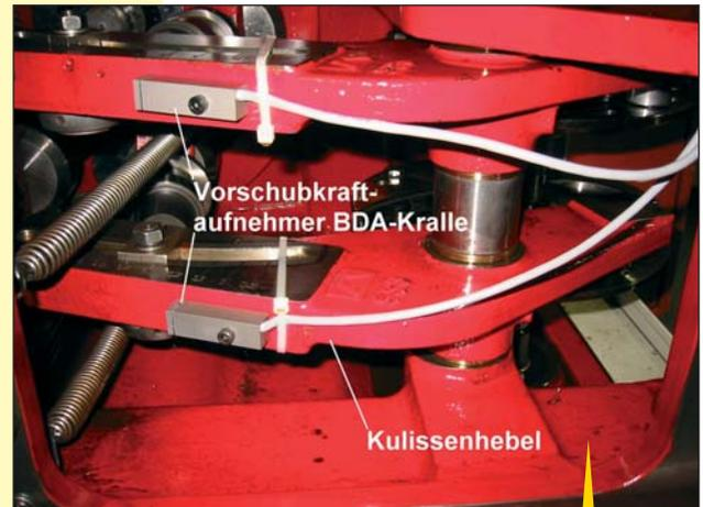
Verschleiß- und Bruchkontrolle im Mehrspindel-Drehautomat per Dehnungsmessung am Kulissenhebel.
