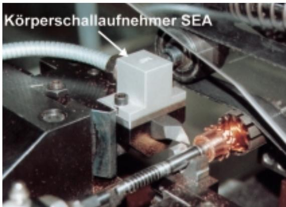
**3 Körperschallmessung beim Kollektordrehen: Spezialmaschinen ermöglichen teilweise eine Anordnung des Schallaufnehmers direkt am Werkzeug**
