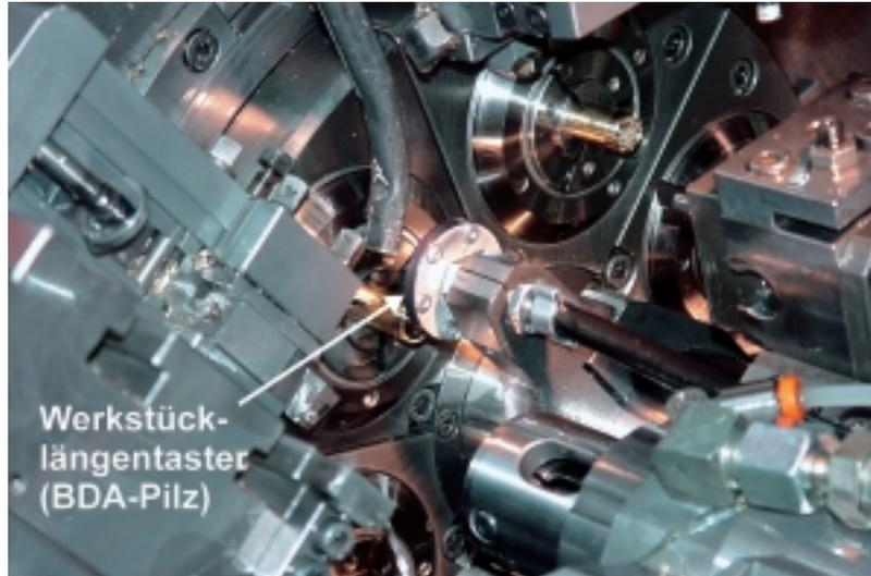
6 Sicheres Weitertakten von Werkstücken: Werkstücklängenkontrolle beim Weitertakten der Werkstücke mit einem so genannten BDA-Pilz im Mehrspindel-Drehautomaten
