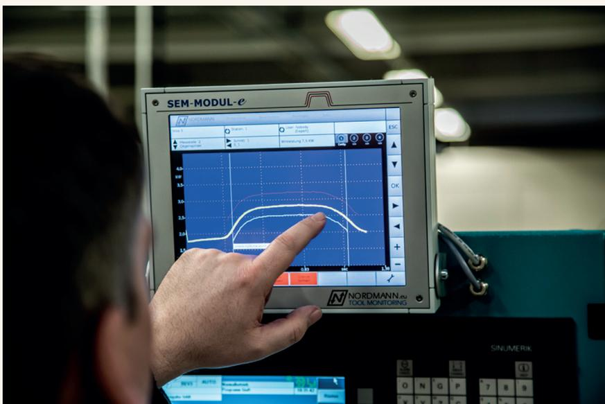
Bild 2: Die Grenzwerte (Hüllkurven) können berechnete Bediener mit dem Finger in Höhe und Form verändern
