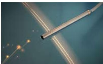
Bild 4: Der infolge des Schneidenausbruchs entstehende Funkenflug wird mit einem "Spark-Sensor" gemessen (Werkbilder: Nordmann GmbH & Co. KG, Hürth)
