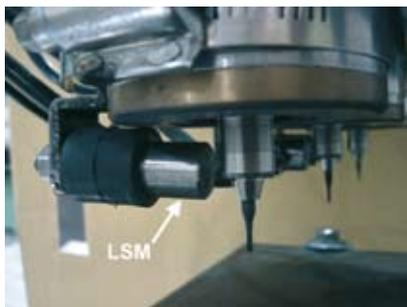
Bild 3: Bei der Trockenbearbeitung wird per Luftschallmessung das Vorhandensein von Werkzeugen über deren Schnittgeräusch kontrolliert
