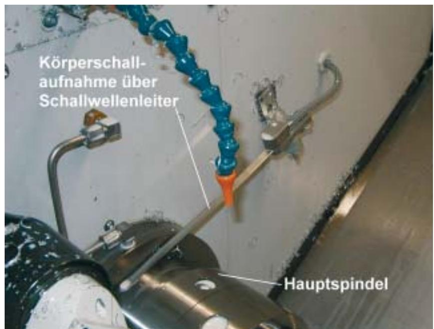
Bild 8: Der Schallwellenleiter aus Federstahl fühlt an der Hauptspindel
