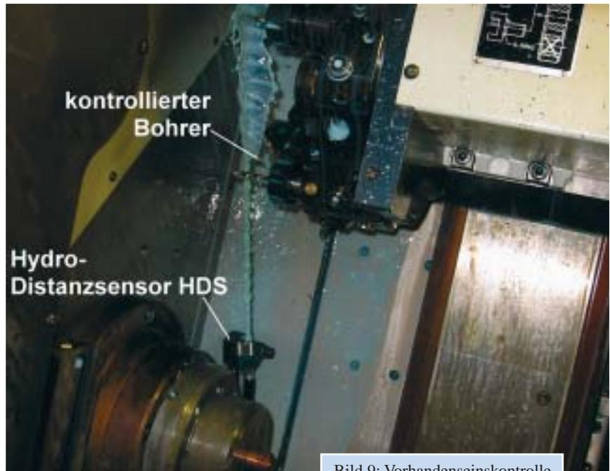
Bild 9: Vorhandenseinskontrolle eines Bohrers über einen Emulsionsstrahl als Taster
