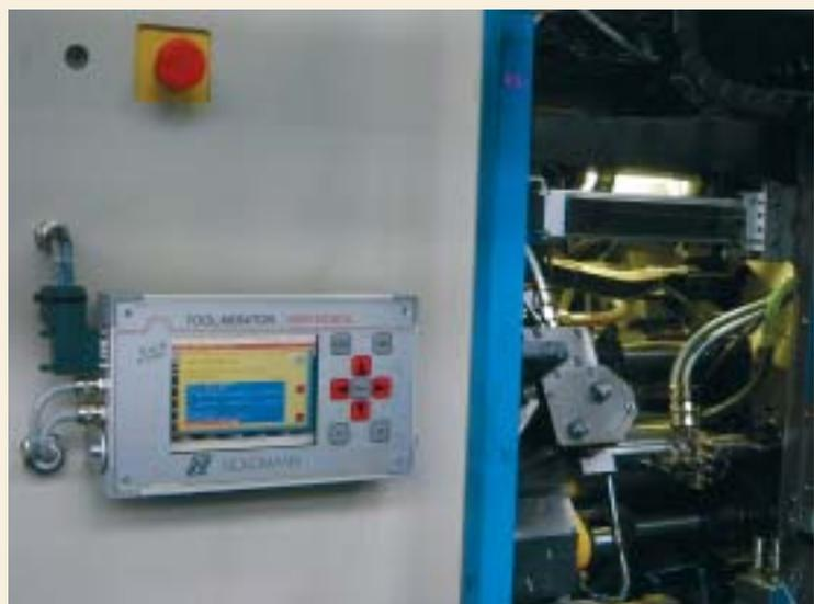
Bild 3 (oben): Messung der Vorschubkraft über die Stauchung der Vorschubstange
