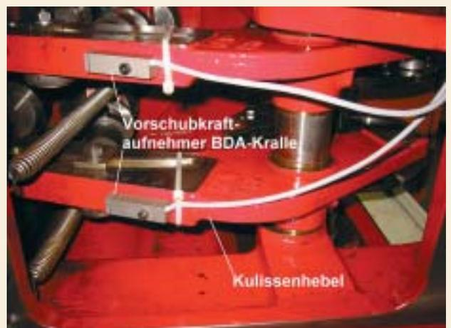
Bild 2: Kraftaufnehmer zur Vorschubkraftmessung über eine Messung der elastischen Verbiegung der Kulissenhebel
