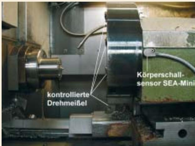
Bild 6: Körperschallmessung am Revolverkasten einer Traub-Drehmaschine
