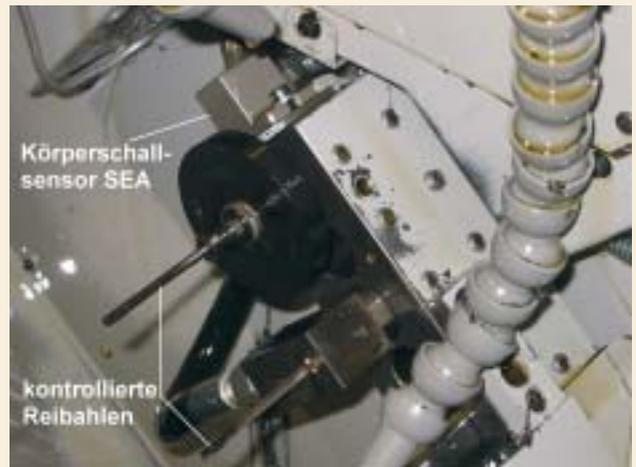
Bild 7: Körperschallaufnahme zur Kontrolle der Reibahlen
