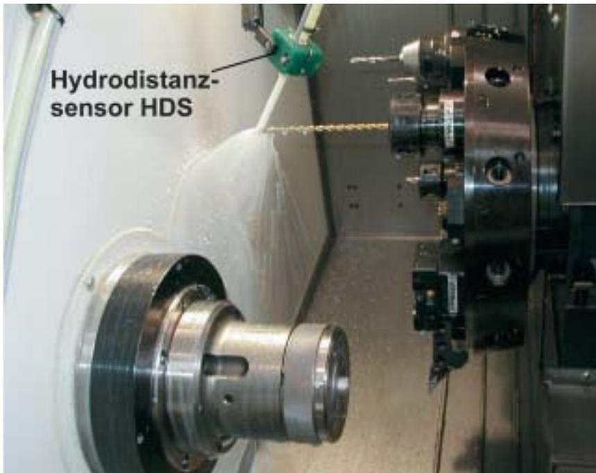
Bild 5: Der Hydrodistanzsensor kontrolliert das Vorhandensein der Werkzeugspitze über einen Emulsionsstrahl als Tastmedium
