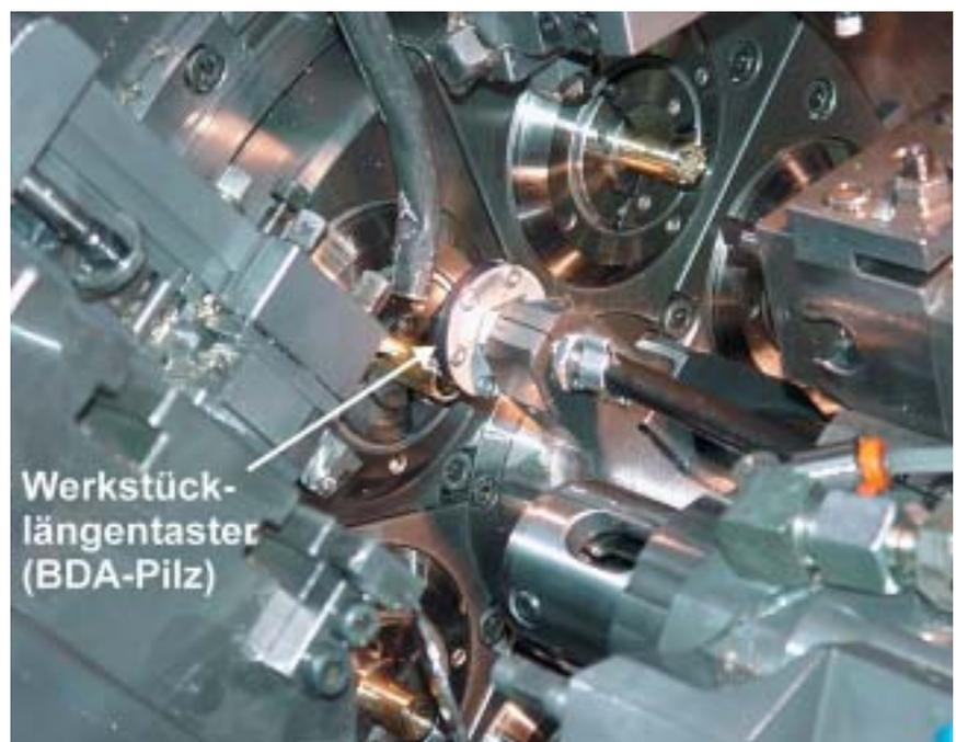
Bild 6: Werkstücklängenkontrolle im Mehrspindel mit einem Fühler zwischen zwei Lagen, an dem die Werkstücke vorbeistreifen
