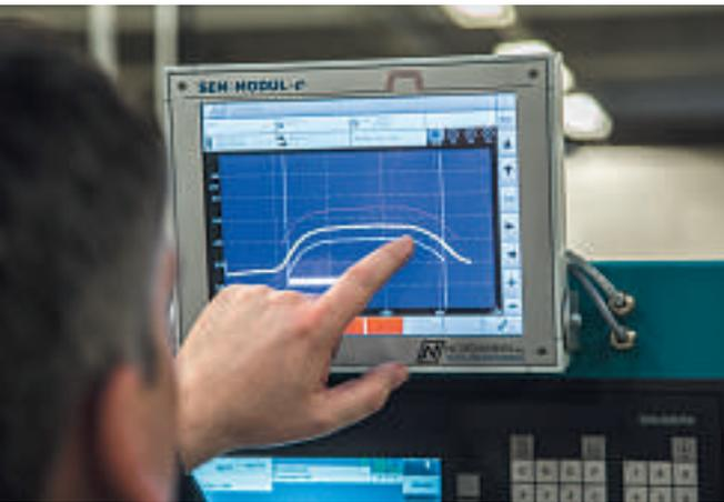
Bei dem Werkzeugüberwachungssystem SEM-Modul-e können berechnete Grenzwerte mit dem Finger in Höhe und Form verändern. (Bild: Nordmann)
