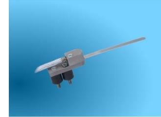
**SEA-Feder** (patentiert) **Schall-Emissions-Aufnehmer mit Federstahlelement.** Piezoelektrische Messung der per Körperschall zum Sensor übertragenen Schallemission von Werkzeugen, die bei der Zerspanung und dem Werkzeugbruch entstehen.
