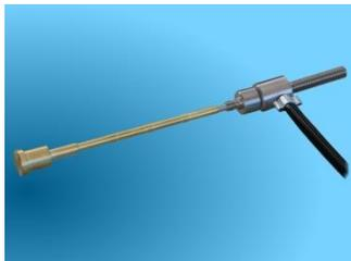
RSA-2 Rotierender Schallemissionsaufnehmer mit Messwertübertragung durch das Zentrum einer Spindel. Zum Einbau in den Rotor einer Spindel mit räumlich getrennter Anbringung des Sensors und des Senders.
